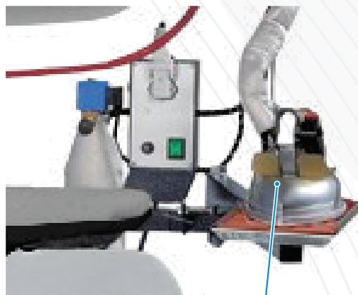
Ferro tulipano elétrico para auxiliar no melhor acabamento.
